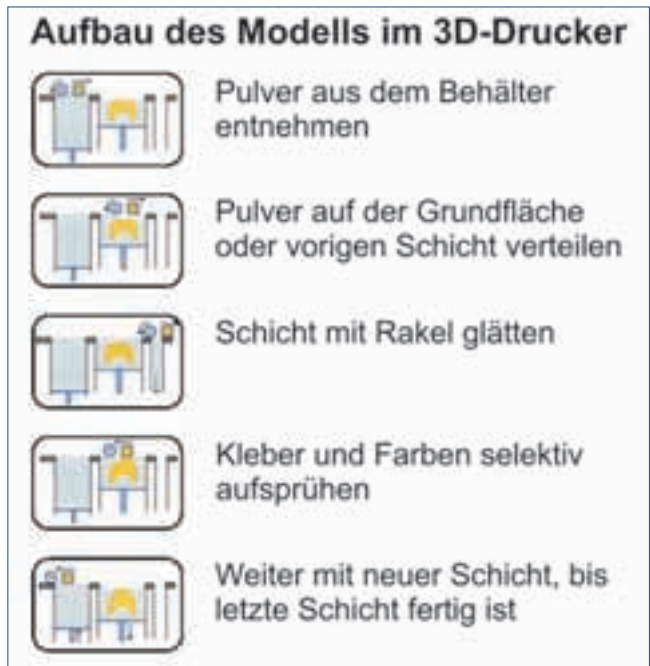
Bild 1: Produktionsschritte für den Aufbau des Modells im 3D-Drucker.
