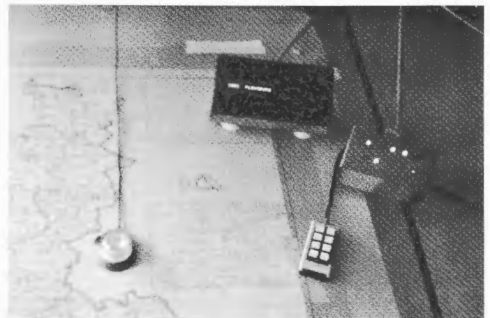
Bild 2. Interaktiver Digitalisierplatz. Die Fadenkreuzlupe (links) wird auf den zu erfassenden Punkt gesetzt, dessen Koordinaten auf Knopfdruck vom Rechner übernommen werden. Die Tastatur, die einzeilige Buchstabenanzeige, das Lampenfeld und der darin integrierte akustische Signalgeber dienen der Interaktion zwischen Operateur und Programm, ebenfalls das hier nicht abgebildete grafische Sichtgerät.
