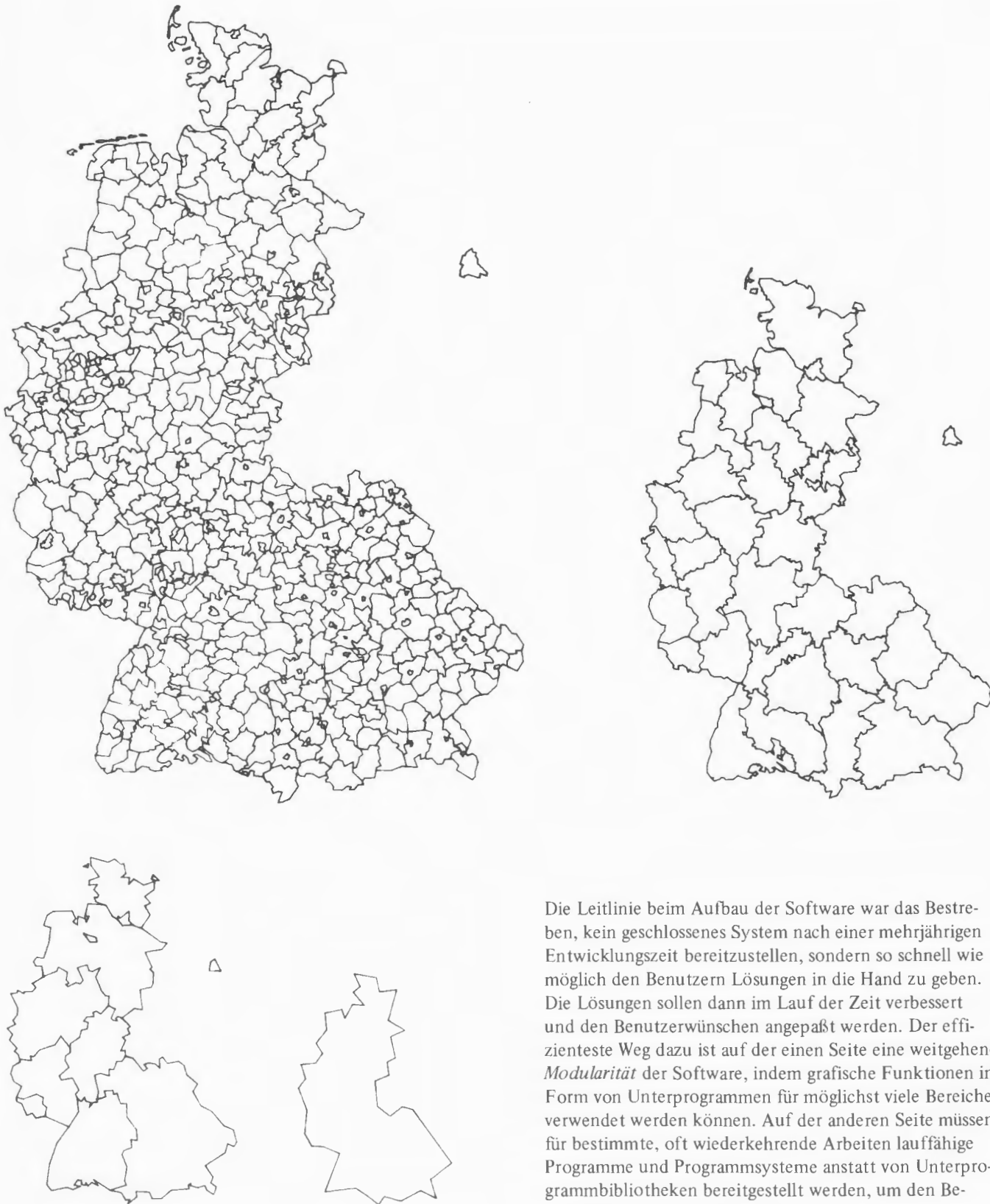
Bild 3. Geometrische Basisdaten. Aus den digitalisierten Kreisgrenzen der Bundesrepublik Deutschland und West-Berlins (links oben) können per Programm die Grenzen aller Bezugsräume generiert werden, die aus Kreisen aufgebaut sind, in diesem Beispiel Regierungsbezirke, Bundesländer und die Bundesrepublik selbst. Gleichzeitig mit der räumlichen Generalisierung wurde die Anzahl der Linienkoordinaten und der Flächen, etwa die Inseln an der Nordseeküste, dem Abbildungsmaßstab entsprechend reduziert.
