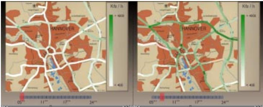
**Abb. 3-12** Darstellung des Verkehrsnetzes durch bandhafte Signaturen konstanter Breite. Die Verkehrsbelastung wird durch einen kontinuierlichen Farbverlauf dargestellt (Entwurf 3, Datei Ani3-9.mov).
