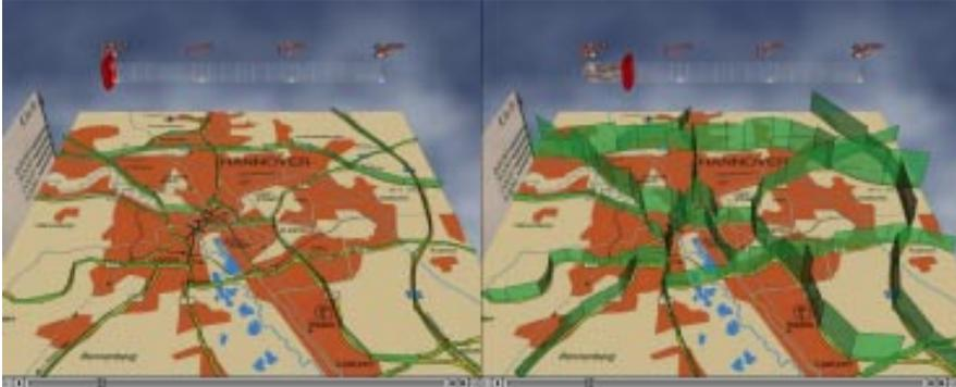
**Abb. 3-13** Perspektivische Darstellung der Verkehrsbelastung mittels vertikaler bandhafter Signaturen einzelner Streckenabschnitte (Entwurf 4, Ani3-10.mov)
